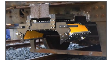
Тимчасове встановлення LTM для перевірки новопрокладеної колії
