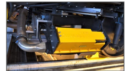
На стаціонарних установках система вентиляторів LTM Protect підтримує лінзи в чистоті
